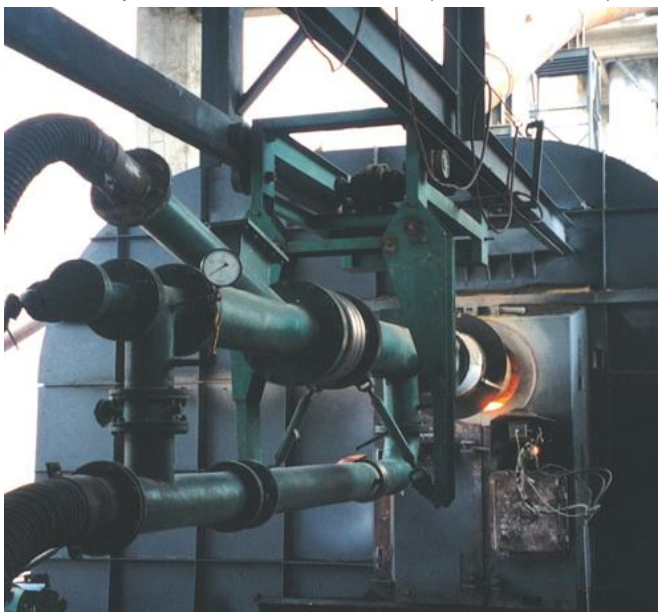
Sistema di precalcinazione del forno (Fonte: internet)
